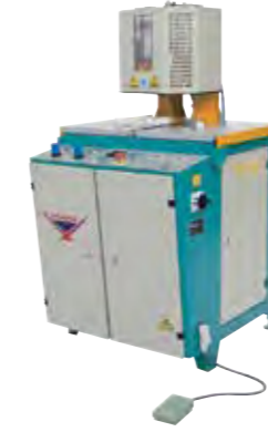
TK 505 (PVC Tek Köşe Kaynak Makinesi)
